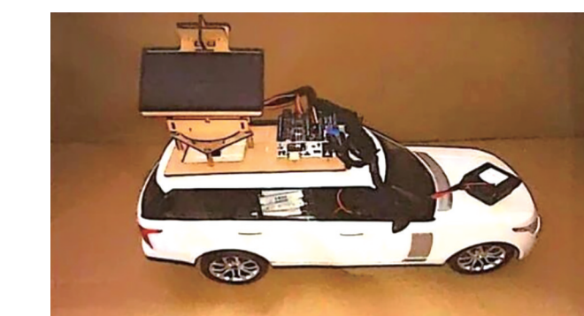
许清心设计的“太阳能追光发电汽车降温装置”。
