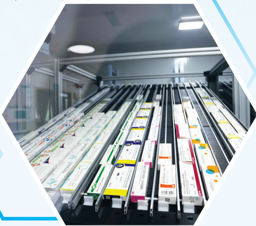
南明区太慈桥街道社区卫生服务中心智慧疫苗自动化工作站，各类疫苗整齐排列在存用一体化冷库对应的滑道中。
